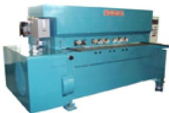
新日鉄技研 150kg/mm<sup>2</sup>鋼板切断用
