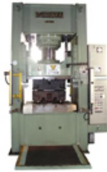
新日鉄技研 200トン疵試験プレス700角
